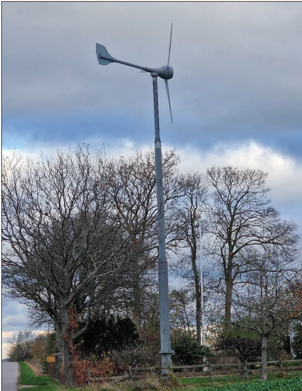
Figur 2-1. Eksempel på husstandsvindmølle (R9000 Britwind 5 kW). Møllen er udviklet til opstilling i landzone og industriområder ved f.eks. landbrug, værksteder, institutioner m.m.
