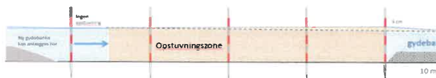
Figur 9 Principskitse for, hvordan man vha. landmålerstokke med mærkninger af vandstandsforholdene kan sikre sig, at man ikke påvirker opstrøms beliggende områder, når man udlægger en eller flere gydebanke.
